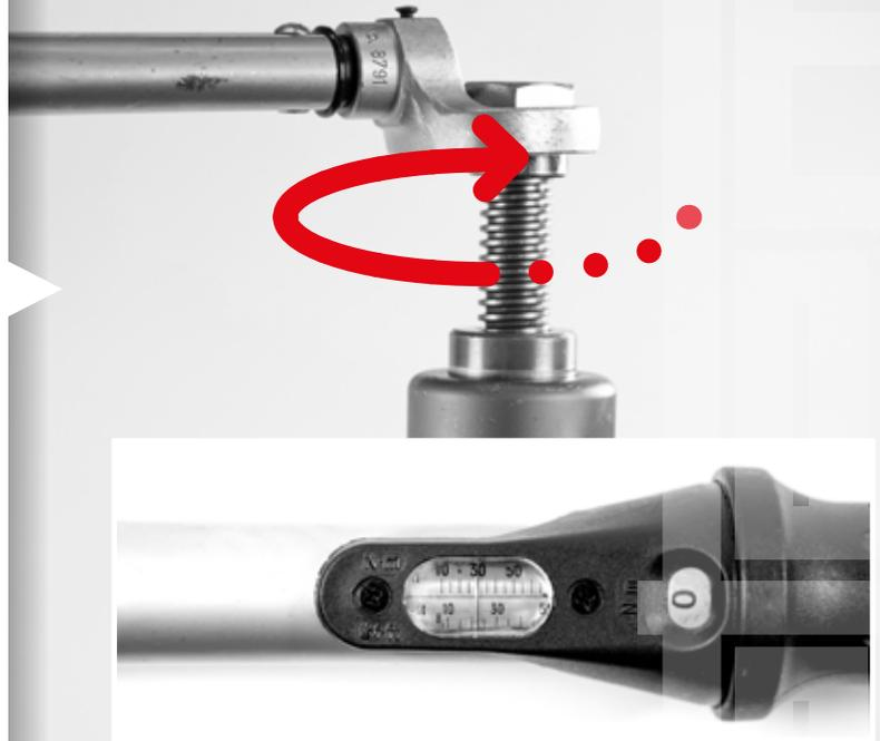
**5** Schrauben Sie die Düsenmutter mit der am Drehmomentschlüssel montierten **19mm**-Stecknuss ab.
