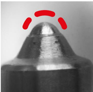
⚠ Das Bild zeigt die Folgen der Verwendung einer falschen Spitze, bei der sich die Kontaktfläche auf der sphärischen der Düse befindet. In diesem Fall führt die Einwirkung einer bereits relativ geringen Kraft zu einer dauerhaften Verformung.
