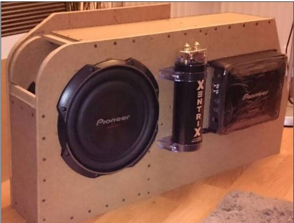
Abbildung 2: Subwoofer-Korpus unbezogen, noch ohne Verrundung der Kante am Frontpanel und Rundbogen, mit Anbauteilen
