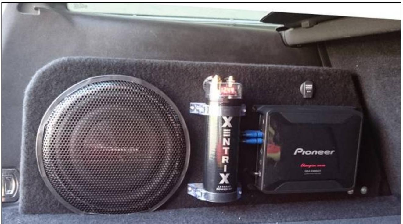
Abbildung 6: Subwoofer-Gehäuse mit Anbauteilen und Schutzgitter vor Subwoofer, Seitenansicht
