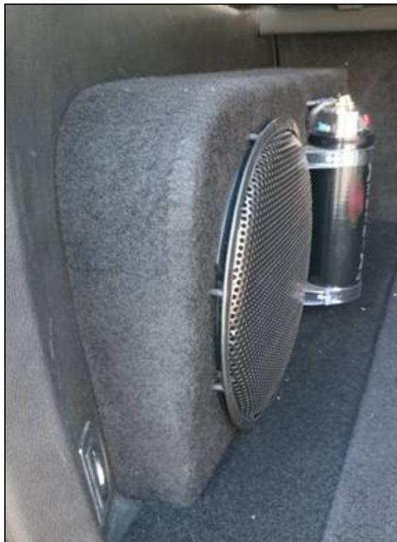
Abbildung 3: Detail Rundbogen und Schutzgitter vor Subwoofer
