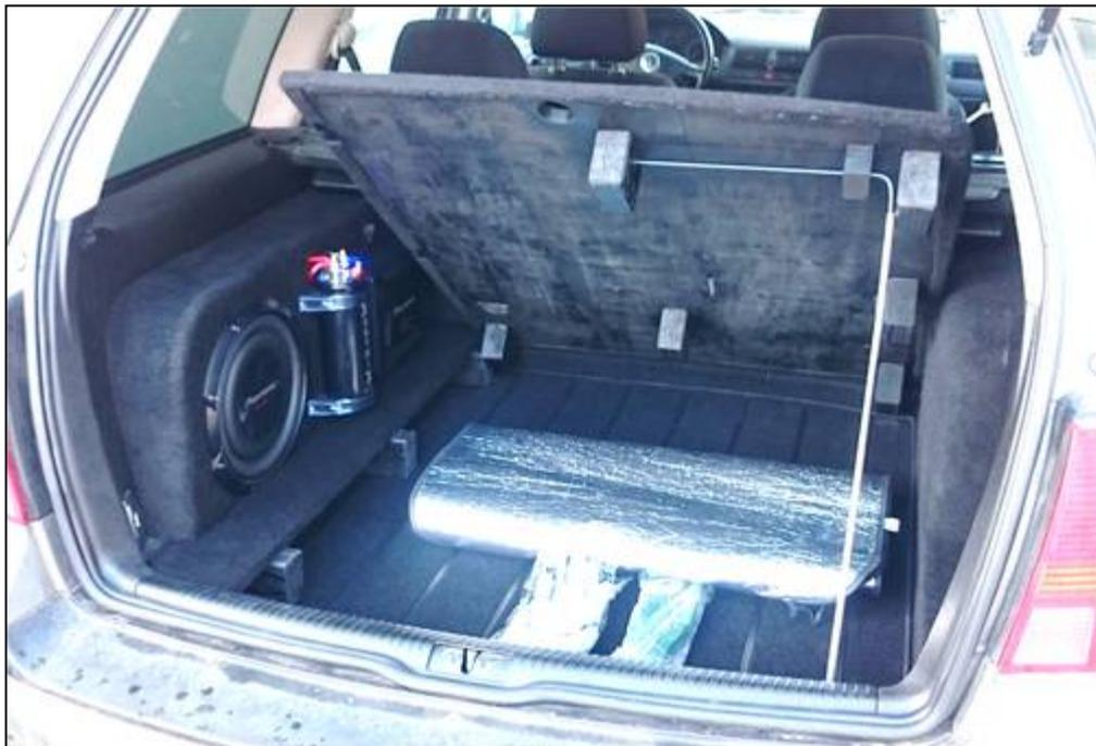
Abbildung 9: Subwoofer-Gehäuse und Ladeboden offen
