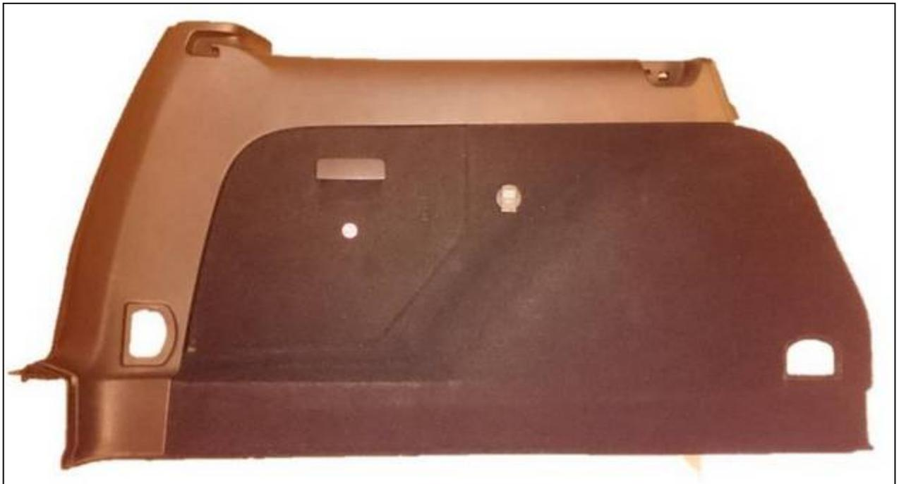
Abbildung 5: Seitenverkleidung Kofferraum, links (schwarzer Nadelfilz in der Mitte muss komplett entfernt werden, wird nicht mehr benötigt)
