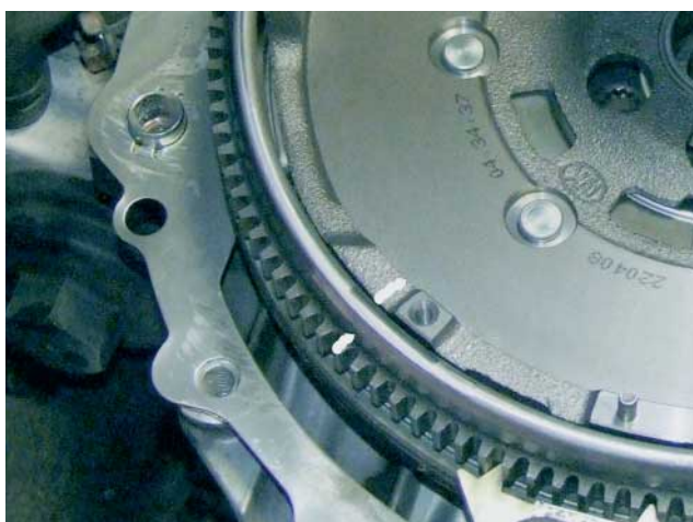
‚Ankreiden‘: Ist der Werkzeughebel nicht mittig zu positionieren, erfolgt das Ermitteln des Freiwinkels nicht durch die Gradscheibe, sondern durch Markierungen, die der Kfz-Profi nach dem ersten Auslenken des Sekundärrades auf diesem und dem Primärrad (Zahnkranz) selbst anbringt. Bild: LuK
