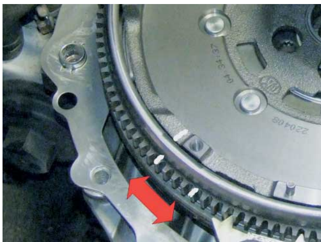
Versetzt: Durch die Anzahl der Zähne, um welche die Sekundärscheibe nach dem Drehen im Uhrzeigersinn versetzt ist, erfolgt die Auswertung des Freiwinkels. Bild: LuK
